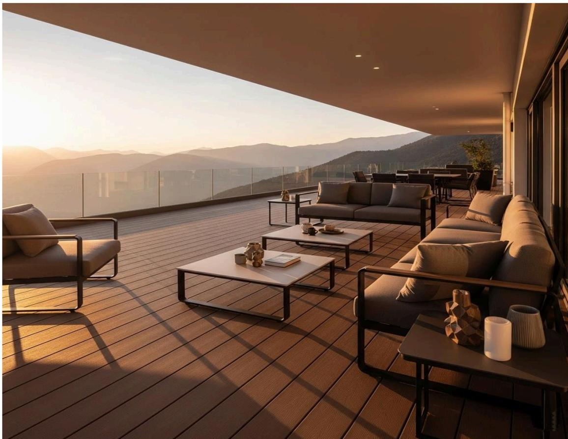
Le doghe in **WPC** sono ottenute per estrusione a caldo da miscela di fibre di legno e polimeri additivi antiossidanti ed esteticamente sono molto simili al legno naturale. Vengono utilizzate per rivestimenti a parete e pavimentazioni esterne grazie allo speciale scudo protettivo che le rendono impermeabili all'acqua e resistenti agli agenti atmosferici, alle muffe, agli insetti, alle spaccature e agli scolorimenti causati dai raggi U.V.
